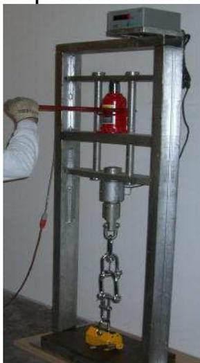
**Teste Prático executado em nossas instalações com dinamômetro aferido por órgão credenciado pelo INMETRO (RBC)**
